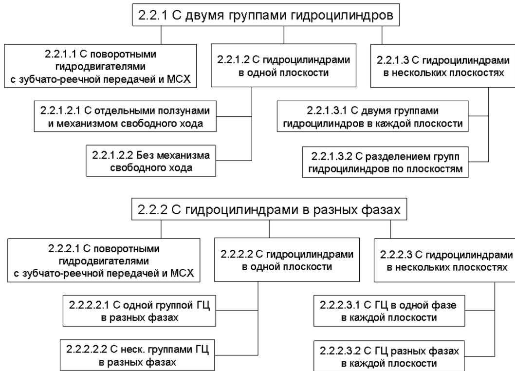
Рис. 3.14. Систематизация компоновочных схем трансмиссии геолода с непрерывным вращением головной секции
